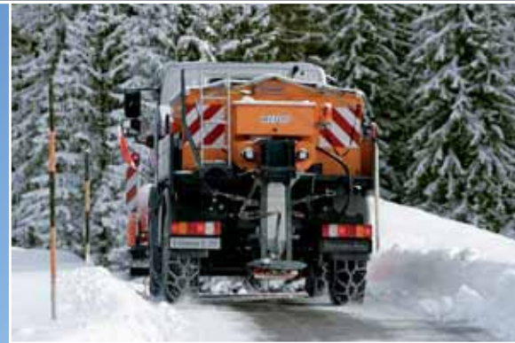
Permanenter Allradantrieb, Differenzialsperren in den Achsen und Single-Bereifung mit Schneeketten ...
