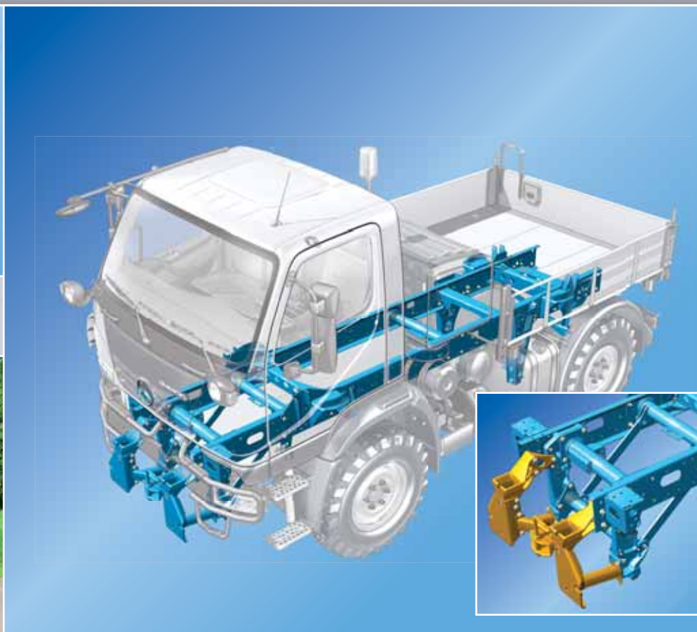
Ein durchgehender, stabiler Leiterraum mit integrierten Befestigungspunkten macht den direkten Geräteaufbau einfacher
