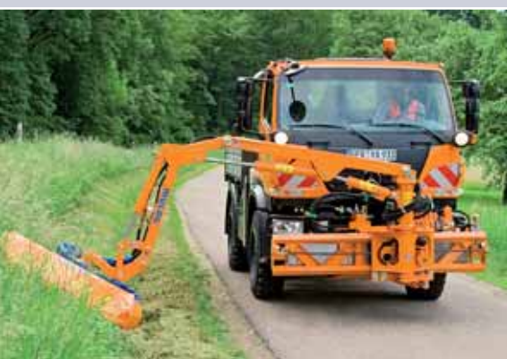
Starke Frontanbauplatte für Randstreifenmäherät, Schneepflug u. a. Geräte
