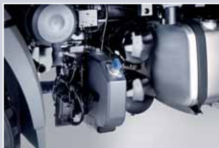
Kompakt: der zusätzliche AdBlue®-Tank mit 25 l Fassungsvermögen
