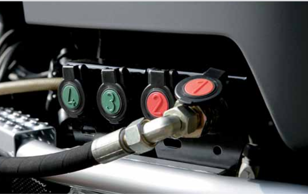
Farblich gekennzeichnete Hydraulikkupplungen – ideal für den schnellen und sicheren Geräteanschluss
