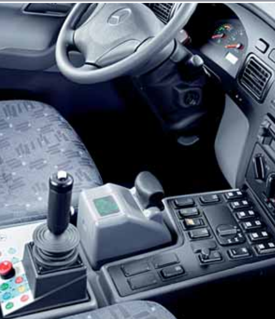
Alles im Griff: mit der übersichtlichen Mittelkonsole und dem Joystick für die Gerätebedienung
