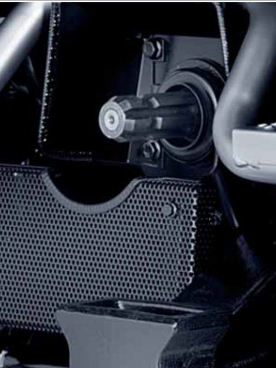
Direkt vom Motor angetrieben – die Frontzapfwelle für den Einsatz von Geräten mit hohem Leistungsbedarf
