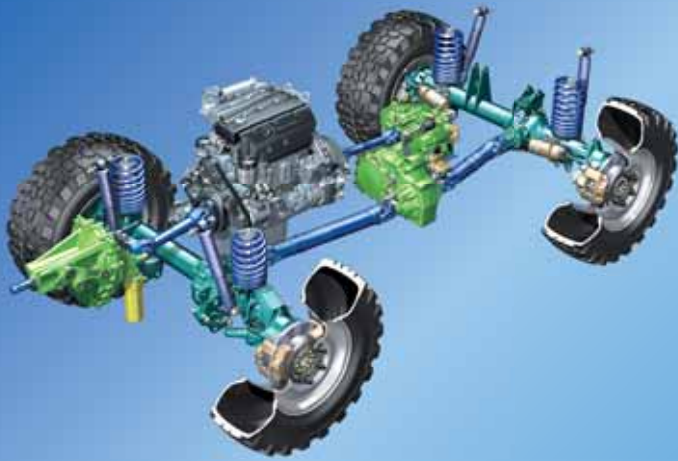
Auch mit Aufbauten immer gut abgedert – dafür sorgen Schraubenfedern mit Teleskopstoßdämpfern
