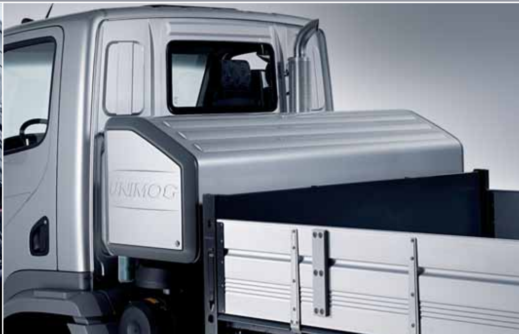
Die Multifunktionsbox bietet viel Raum für Schaufel, Kleingeräte oder Schneeketten – und lässt sich abschließen
