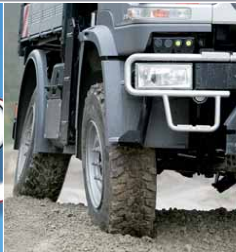
Stark im Gelände durch Achsverschränkung, permanenten Allradantrieb und zuschaltbare Differenzialsperren in beiden Achsen
