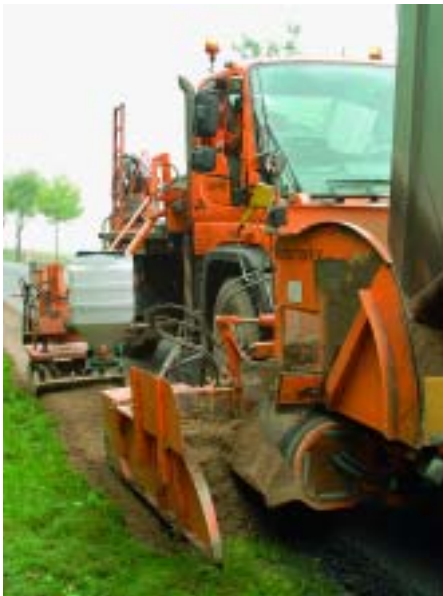
Der Unimog U 500 trägt nicht nur die komplette Gerätekombination, sondern schiebt auch noch den Lkw mit seinem Kippsattel vor sich her
