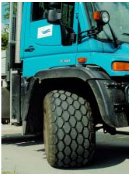
Bretreifen, Bio-Diesel im Tank und biologisch abbaubare Öle für Motor, Getriebe, Achsen, Radvorlegele und Hydraulik sind wichtige Voraussetzungen für eine biologisch einwandfreie Wassergewinnung (oben und linke Seite)
