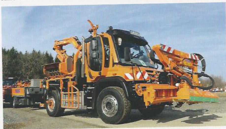
Für Mäharbeiten stattet Mulag den Unimog U 530 mit Front- und/oder Heckauslegermähergerät aus.
