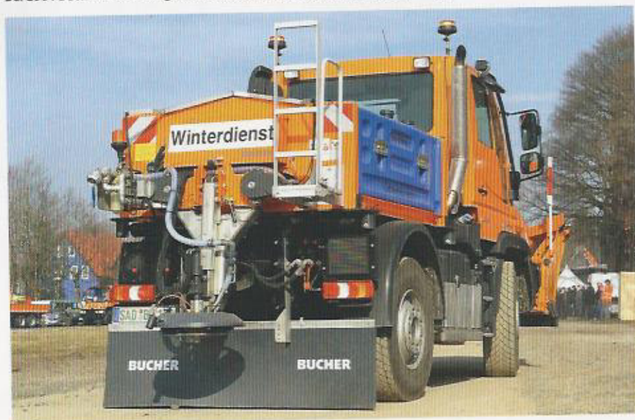
Dank tief montiertem Heckstreuer hält sich das Wankverhalten des Unimog in Grenzen.
